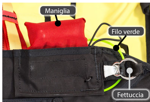
Figura 41 - Componenti Sistema di svincolo dall'alto
