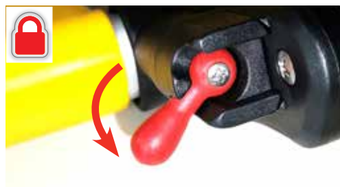
Figure 4 - Levier de verrouillage orienté vers le bas : CIVIÈRE VERROUILLÉE
