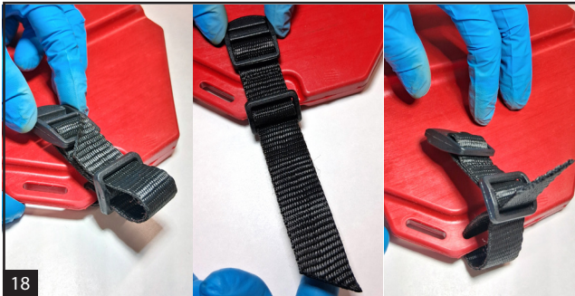
Dégagement du cordon de connexion
