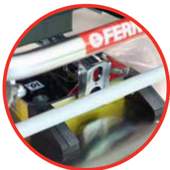
2 Sistema anticaduta lato Slam barelle 5126-EL-IT, 5226-EL-IT e Cortex
