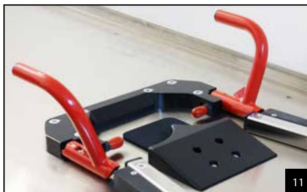
Leve rotanti aperte correttamente
