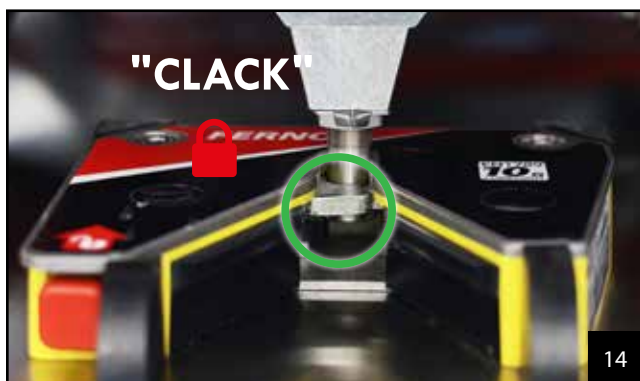
Meccanismo in posizione di blocco
