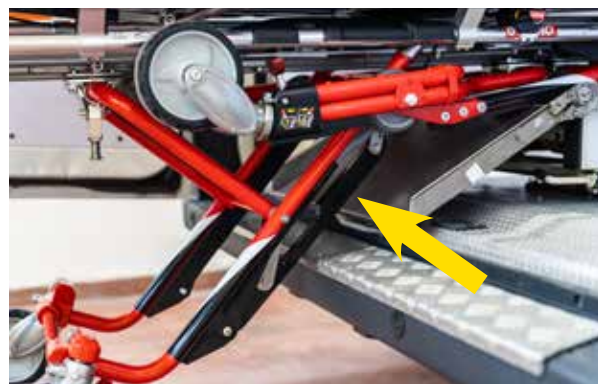
Figura 5 - Sistema di sblocco meccanico gambe posteriori
