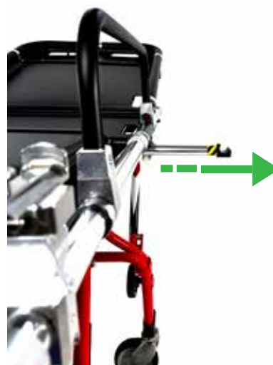
Figure 24 - Extraction des supports latéraux
