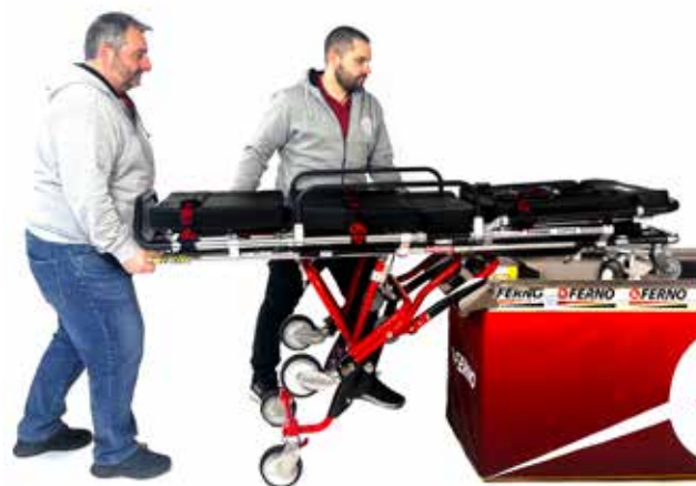
Figure 20 - Chargement et/ou déchargement de la civière
