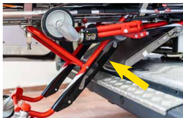
Figure 5 - Système de déblocage mécanique jambes arrière
