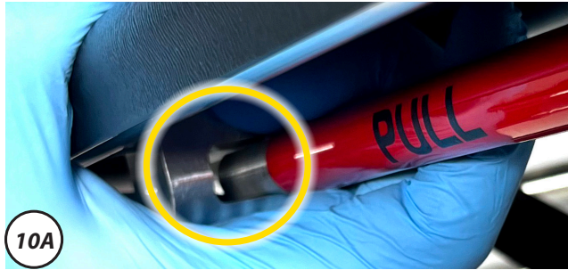
Figure 10 - Actionnement levier cadre pieds
