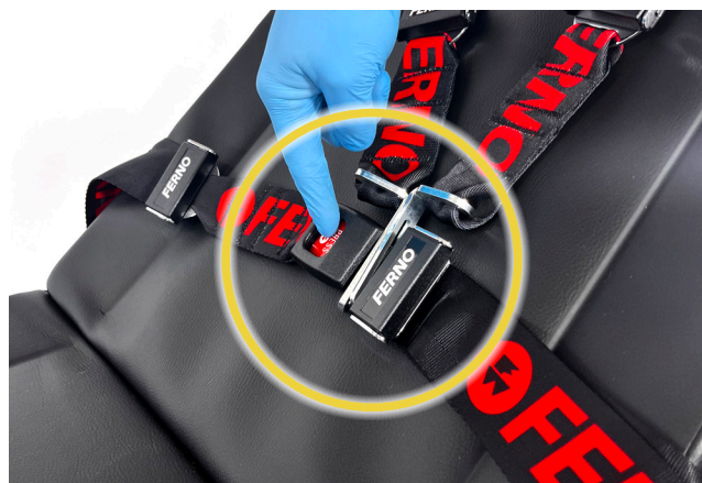
Figure 55 - Ouverture sangle à quatre points
