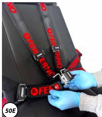
Abbildung 50 - Anbringen des unteren Teils der Hosenträgerbegurtung
