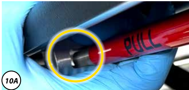
Abbildung 10 - Betätigen des Hebels des Fußrahmens
