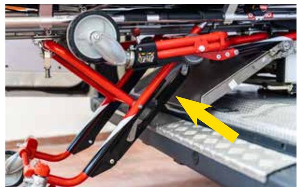
Abbildung 5 - Mechanisches Entriegelungssystem der hinteren Stützbeine
