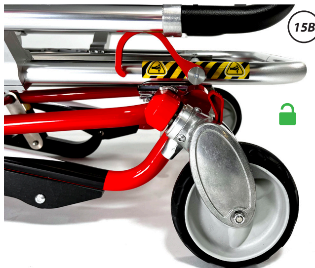
Abbildung 15B: Entriegelter Haken der Beinverriegelung
