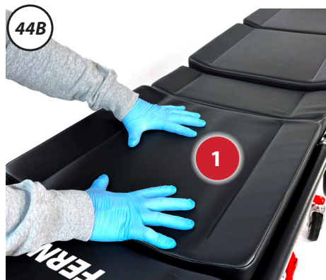
Abbildung 44 - Anbringen des Klettverschlusses der Matratze an Kopfseite
