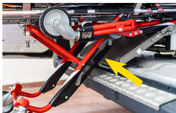
Abbildung 5 - Mechanisches Entriegelungssystem der hinteren Stützbeine
