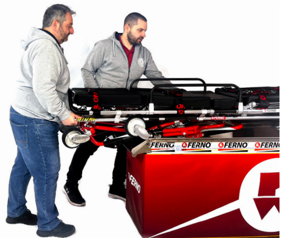
Abbildung 21 - Laden und/oder Entladen der Krankentrage
