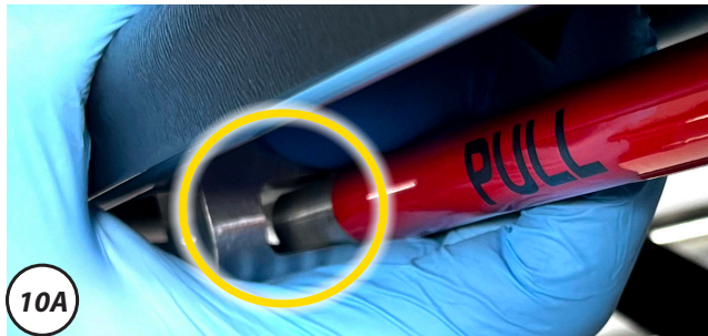
Abbildung 10 - Betätigen des Hebels des Fußrahmens
