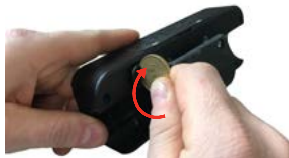
Figura 9 - Apertura vano connettore
