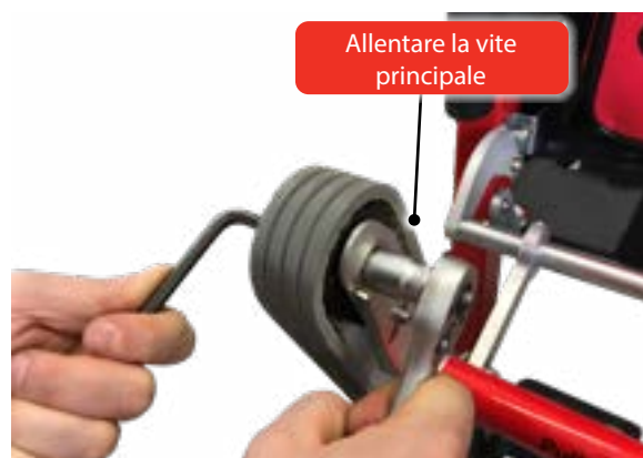
Figura 4 - Allentare la vite principale
