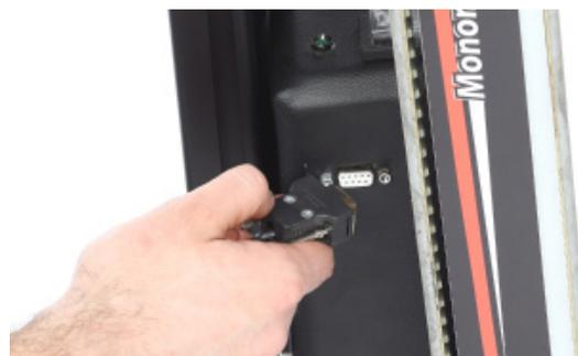
**Abbildung 52 - Anschluss des Kabels am Motorgehäuse**
