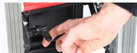
Abbildung 26 - Sicherheitsverschluss
