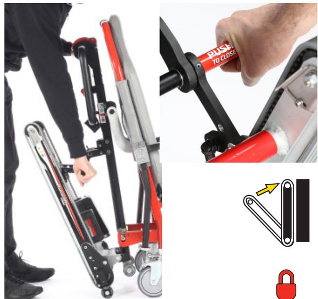
Abbildung 22 - Schließen des Raupenfahrwerks
