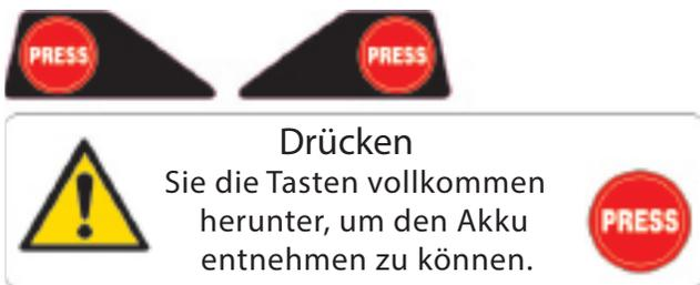
Etikett mit Anweisungen für die richtige Entnahme des Hauptakkus. Das Symbol PRESS ist auf den beiden roten Tasten des Hauptakkus vorhanden.
