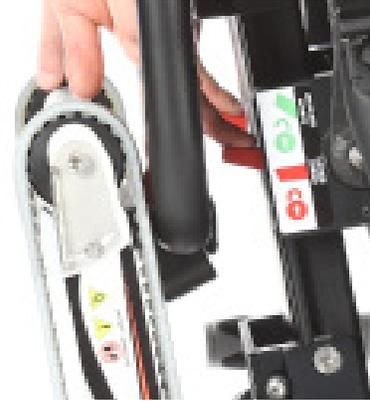
Abbildung 7: Aushaken des oberen Halterungssystems.
