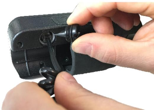
Abbildung 55 - Trennen des Steckers
