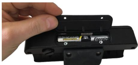
Abbildung 38 - Öffnen des Batteriefachs
