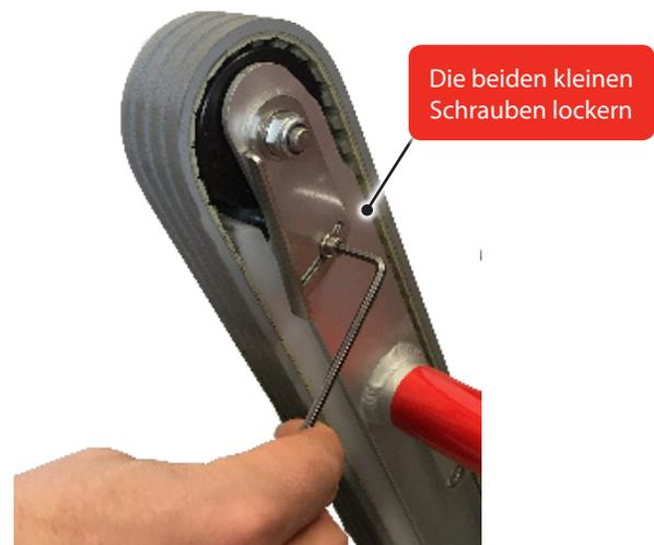
Abbildung 43 - Die beiden kleinen Schrauben lockern
