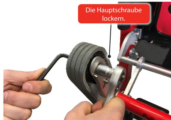
Abbildung 42 - Die Hauptschraube lockern
