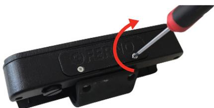
Abbildung 37 - Batteriefach
