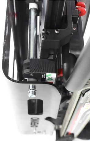
Abbildung 5: Verriegelung des Monorudder am Monoclack.
