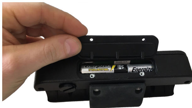
Figure 46 - Ouverture logement des piles
