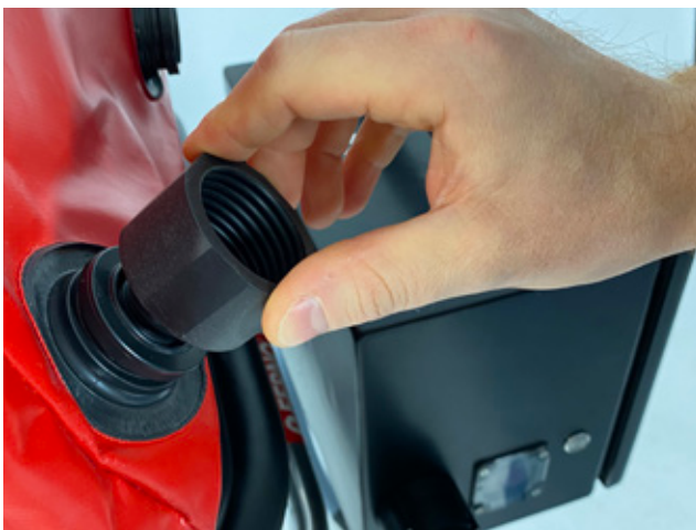
Visser l'adaptateur sur les deux trous externes de la chambre côté tête.
