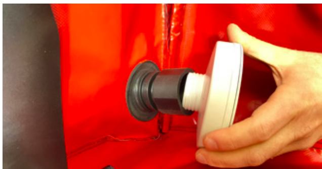
Visser le filtre sur l'adaptateur en s'assurant de bien serrer.
