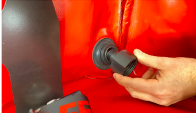
Visser l'adaptateur dans les trous prévus à cet effet dans la chambre de bio-confinement.
