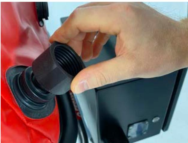
*Den Adapter auf die beiden äußeren Öffnungen der Kammer an der Kopfseite aufschrauben.*
