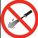
Das System nicht mit einem Hochdruckreiniger reinigen.
