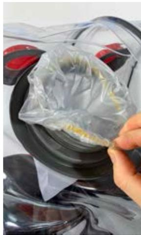
*Den Gummiring über das Ende der Handschuhe streifen und um den Flansch der Öffnung legen.*
