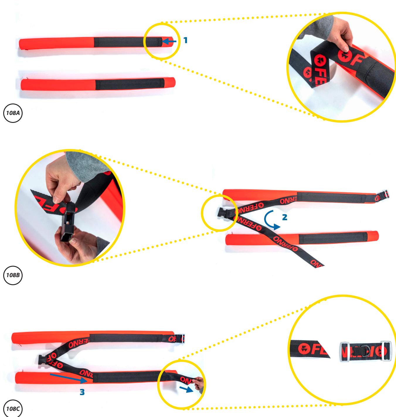
Figura 108 - Assemblaggio cintura di contenimento sui galleggianti pettorali
