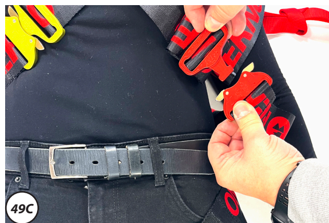
Figura 49 - Applicazione cinture toraciche
