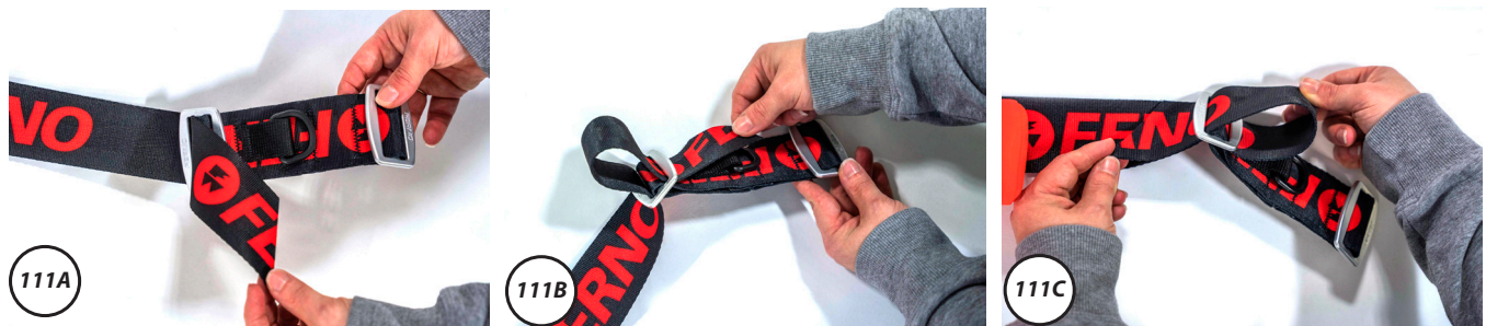
Figura 111 - Passaggi di chiusura finale in dettaglio
