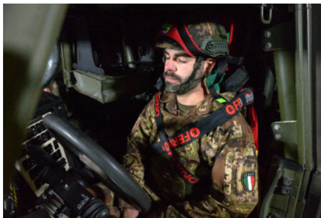
Figura 75 - Posizione corretta delle cinghie toraciche
