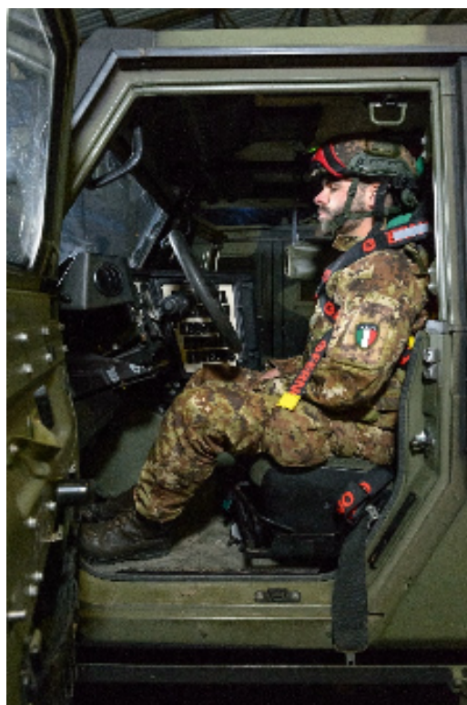
Figura 78 - Cinghie toraciche fissate (Lato)
