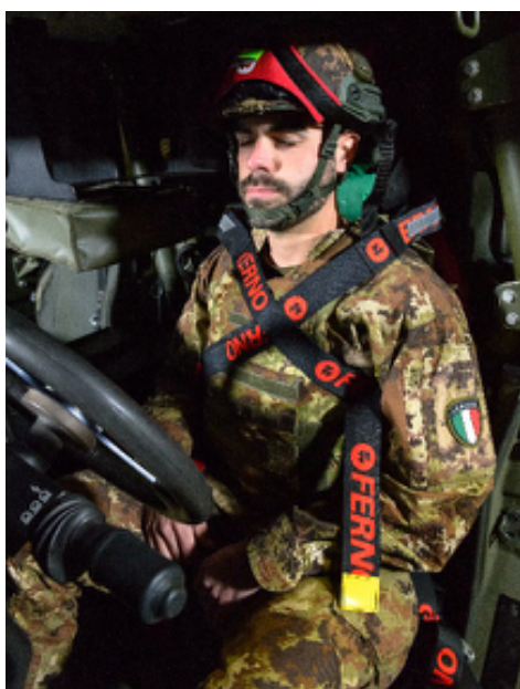
Figura 77 - Cinghie toraciche fissate (Fronte)
