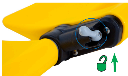
Figura 2 - Levetta di bloccaggio rivolta verso l'alto: BARELLA SBLOCCATA
